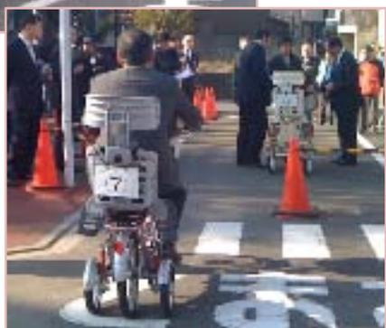
全車を試乗した結果、完成試乗車を待たなければはっきりとしたことは言えないが、少なくとも子どもを持つ母親たちが口をそろえて希望している「転倒しない/押し歩いても転倒しにくい」というニーズを満たしている試作車は見あたらなかった。これは、現行の「普通自転車」(歩道通行が許される規格)の幅60cm以内、長さ190cm以内を満たすとともに、自転車としての操作性を重視して設計されたためと思われる。
